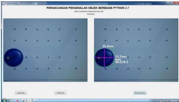
Gambar 12. Posisi benda kerja dengan error koordinat sumbu y terbesar
