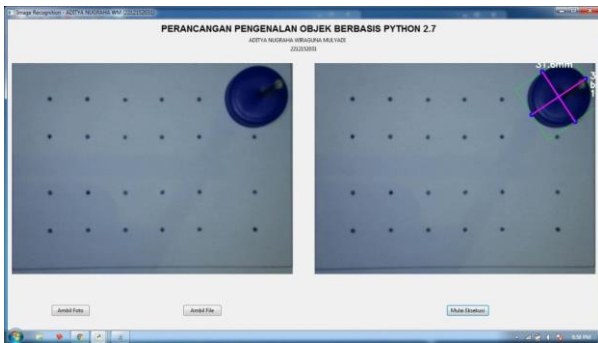
Gambar 11. Posisi benda kerja dengan error koordinat sumbu x terbesar
