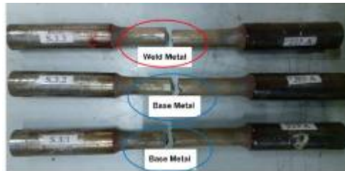
Gambar 13 Hasil pengujian tarik untuk amper \pm 325A
