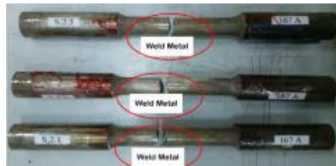
Gambar 12 Hasil pengujian tarik untuk amper \pm 273A
