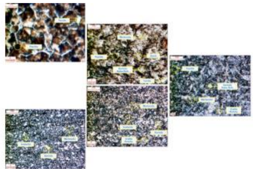
Gambar 21 Struktur mikro hasil pengelasan amper \pm 325A di tiga daerah hasil pengelasan bahan AISI 1065 & HSS
