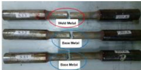
Gambar 13 Hasil pengujian tarik untuk amper \pm 325A
