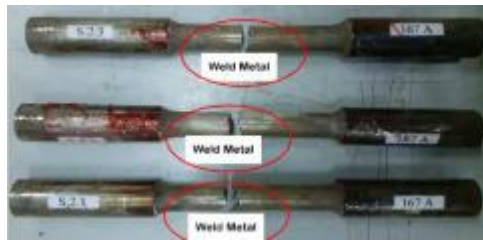
Gambar 12 Hasil pengujian tarik untuk amper \pm 273A
